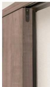
方立と扉のクリアランスを15mmに設定し、隙間をふさぐパッキンを軟質ゴム製とすることで、指はさみなどの安全性に配慮。また、高さが異なる2枚のヒレを対面させて配置し、閉鎖時にパッキンが重なることで遮音性を確保します。
