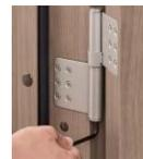
ドアの下部についている丁番の下部を六角レンチで回すと、上下位置を調整できます。(上方向:約4mm、下方向:約2mm)
